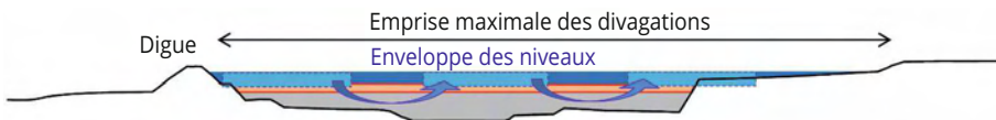
Figure 5-40. Illustration de la détermination de l'enveloppe des niveaux (dans le cas d'un lit divagant) (Source : Y. Quefféléan, ONF-RTM).
