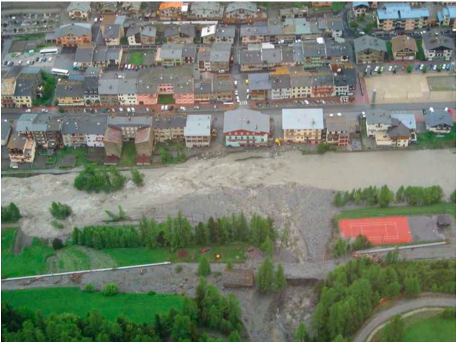
Figure 3-12. Débordement en rive droite de l'Arc à la suite de l'obstruction de la zone de confluence par des bouffées de laves torrentielles du torrent de la Madeleine - Lanslebourg (73) - mai 2008 (Source : ONF-RTM).
