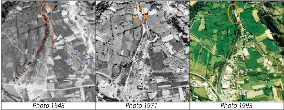
Figure 5-33. Analyse diachronique sur le cône de déjection du torrent du Palps (Risoul 05) (Source : ONF - RTM 05).
