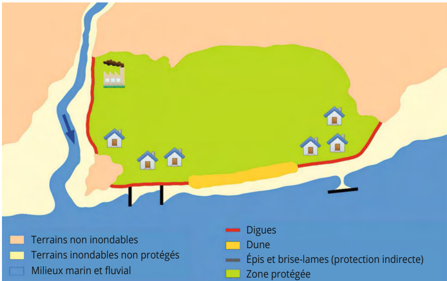
Figure 2-68. Système mixte en embouchure (Sources : R. Tourment, B. Beullac).
