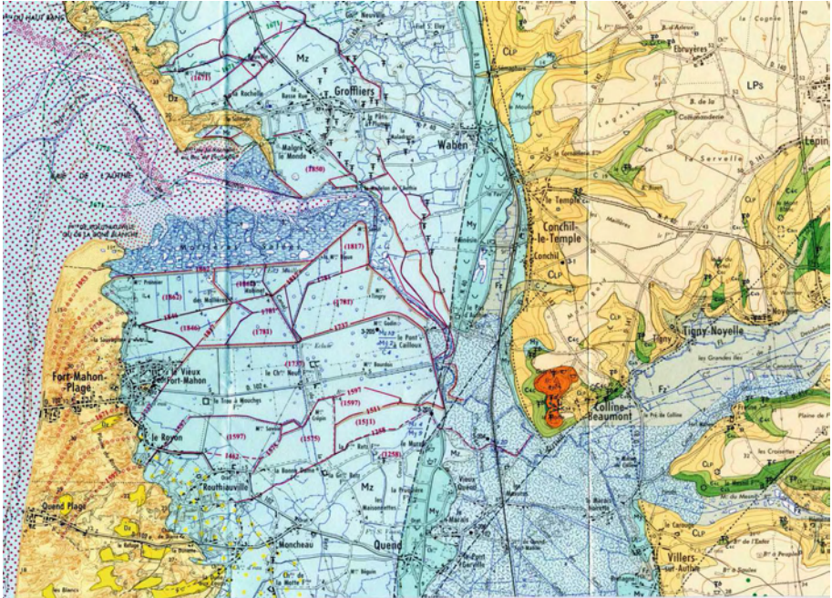
Figure 2-50. Baie de l'Authie (Marquenterre) : carte de 1984 du BRGM montrant les diges (royons) construites pour créer des polders (renclotures) (Source : BRGM, 1984 ; disponible à l'adresse suivante : https://commons.wikimedia.org/wiki/File:Royons_Marquenterre_BRGM.jpg ).
