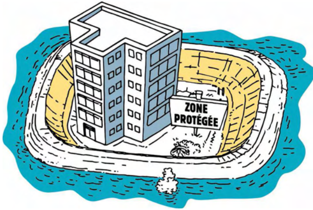
Figure 2-39. Digue de protection rapprochée (Source : CEPRI. Les ouvrages de protection contre les inondations, s'organiser pour exercer la compétence GEMAPI et répondre aux exigences de la réglementation issue du décret du 12 mai 2015. CEPRI, février 2017 [6]).
